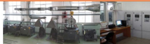
Оборудование для мойки и пропитки якорей и остовов ТЭД регенерации мощного раствора и пропиточного лака
