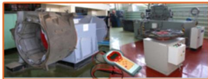
Рабочее место для ремонта остовов ТЭД
