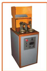
Установка притирки золотниковой части кранов машиниста ПРТН.443239.100
