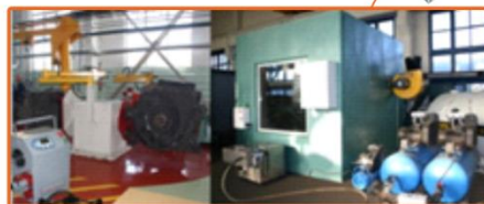
Комплекс очистки ТЭД гранулами сухого льда
