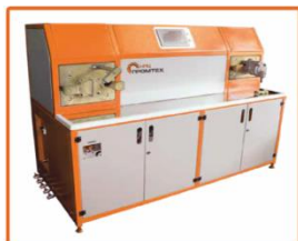
Стенд комплексных испытаний воздухораспределителей ПРТН.422512.013
