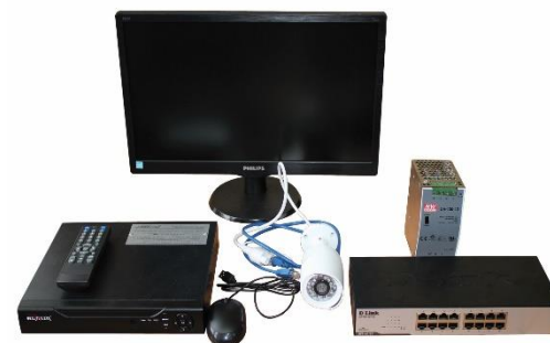
Изолированное рабочее место оператора с выводом изображения от камер наблюдения ПРТН.411711.009
